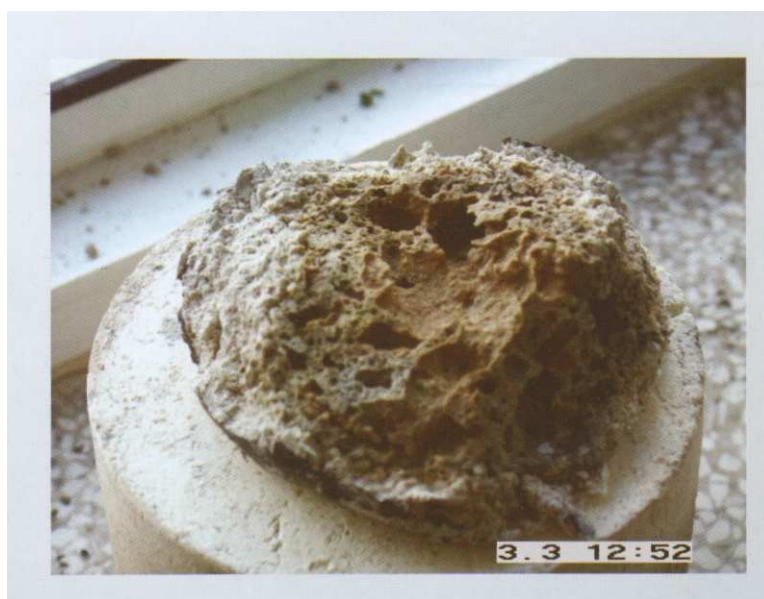
Fot. 2. Produkt po procesie spalania wyrobu zawierającego azbest – całkowicie pozbawiony szkodliwych włókien azbestowych
