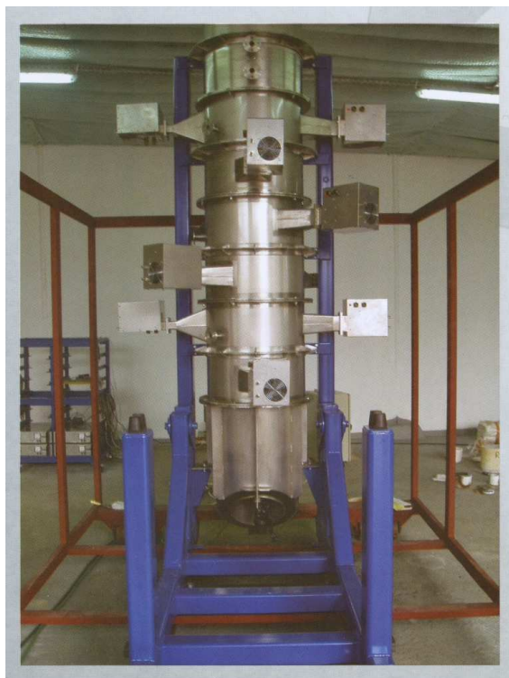
Fot. 3. Specjalna platforma z reaktorem spalania odpadów azbestowych pozwala na unieszkodliwianie odpadu w miejscu jego powstawania*
